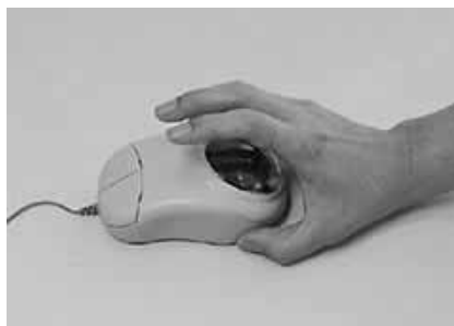
第 3 図 富士通のマウスに静脈パターンを組み込んだ認証装置
